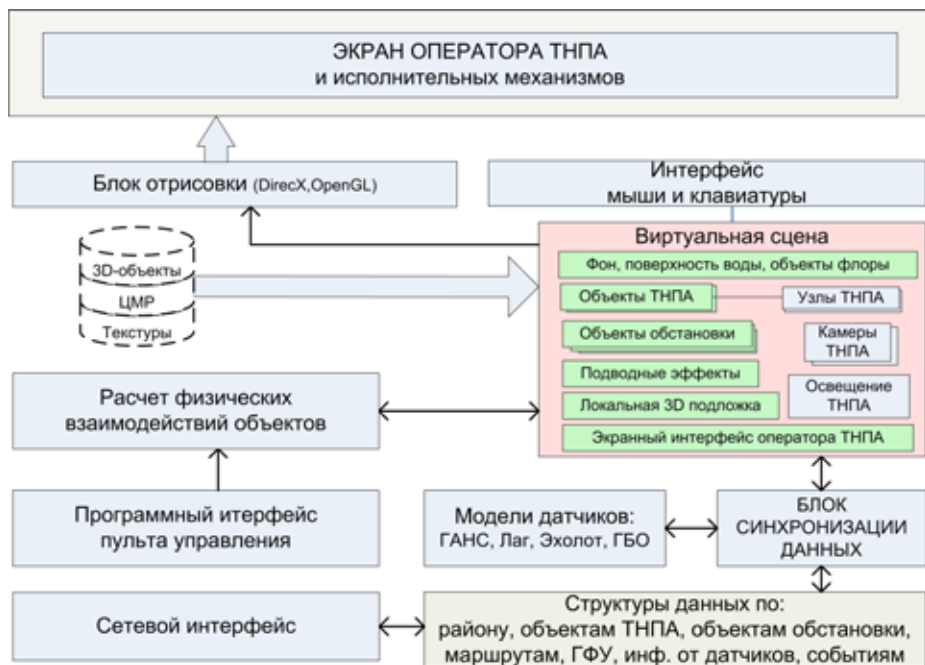
Рис. 8. Структура программы оператора ТНПА
