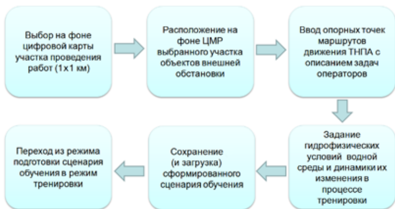
Рис. 6. Последовательность действий инструктора при подготовке сценария обучения
