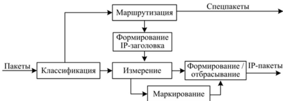
Рис. 4. Схема согласования трафика на пограничной части узла мультипротокольной ТКС
