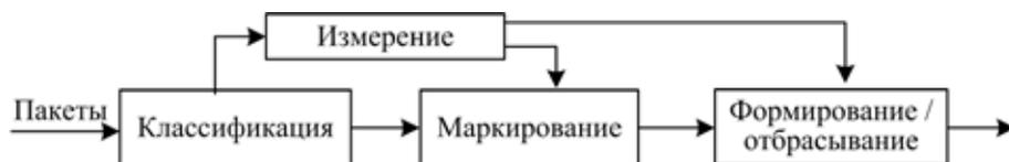
Рис. 2. Схема согласования трафика на пограничном узле
